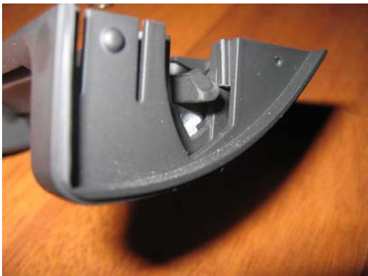
Defekt: Ein Stift ist abgebrochen
