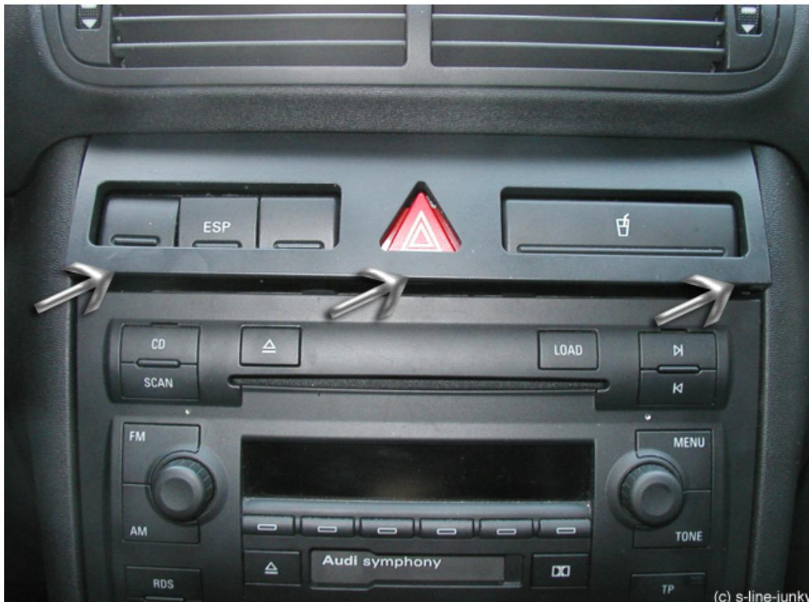
Am einfachsten lässt sich die Blende zuerst an den 3 aufgezeigten Punkten an der Unterseite abklippsen. Anschließend kann die obere Seite an 2 Punkten abgeklippst werden. Hier noch ein Foto der Rückseite der Blende, hieraus gehen die Ansatzpunkte noch einmal deutlich hervor:
